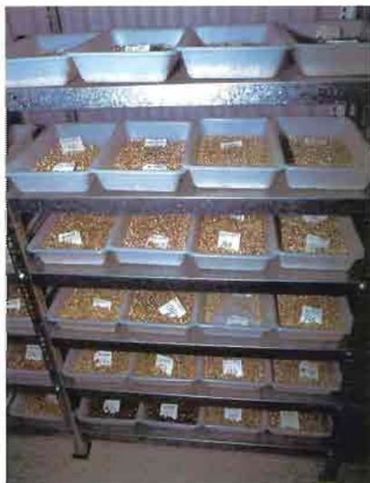
Fig. 11.- Cámaras de desecación de semillas del CRF-INIA. Las entradas se mantienen varias semanas en condiciones de 20°C y 20% de humedad relativa hasta alcanzar una humedad interna menor del 7%.
